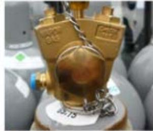
**3** Umsteckhandrad in Mittelstellung: ohne Funktion, keine Entnahme möglich. Jede Entnahmeart hat ein eigenes Ventilanschlussgewinde sowie einen Vierkant für das Umsteckhandrad.
