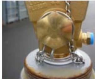
**6** Bei Rückgabe der Flasche die Sechskant-Verschlußmutter des Flaschenanschlussgewindes aufschrauben. Das Umsteckhandrad auf den mittleren Vierkant (Auslieferungszustand) aufstecken.
