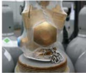
**2** Folie entfernen. Produktentnahme je nach Position des Umsteckhandrads in flüssiger oder gasförmiger Form.
