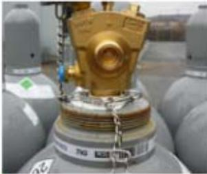
**5** Hochdruckschlauch an Flasche und Kundenanlage anschließen. Umsteckhandrad vorsichtig öffnen. Schlauchanschlüsse auf Dichtigkeit prüfen! Nach Beendigung der Arbeiten das Flaschenventil mittels Umsteckhandrad handfest schließen.
