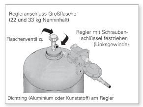
Bei Flaschenwechsel den Regleranschluss erst dann lösen, wenn das Flaschenventil vollständig (im Uhrzeigersinn) zugedreht ist. Der Druckregler muss gut dichtend
